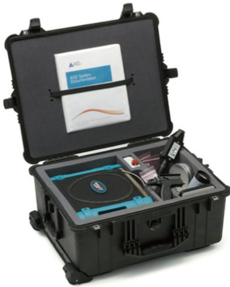
FieldSpec 4 Hi-Res增加了信号流量，提高了光谱分辨率，相比以前模式大幅提高了信噪比。对遥感而言，这意味着在野外更快速的光谱采集和更高的光谱质量。研究者在长波近红外区分物质的时候，例如碳酸盐、粘土和绿泥石，在长波近红外区1和2（SWIR1,2）范围，由于两倍辐射强度增加使得测试效果更好。The FieldSpec 4 Hi-Res的分辨率为8nm，可完美地建立光谱实验室，因为它可以提供更高要求的高光谱分辨率的谱图，来支持目前和以后的高光谱传感器。FieldSpec 4 Hi-Res非常适合需要蚀变矿物绘图的地质应用，同时也适用于高光谱成像验证和地面实况测量。
